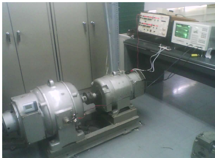
Figura 4.4 Posicionamiento en eje directo de un generador síncrono sin escobillas, ubicado en el laboratorio de motores eléctricos en el Instituto de Investigaciones Eléctricas, con capacidad de 650 kVA
