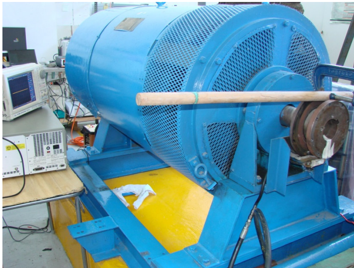
Figura 4.4 Posicionamiento en eje directo de un generador síncrono sin escobillas, ubicado en el laboratorio de motores eléctricos en el Instituto de Investigaciones Eléctricas, con capacidad de 650 kVA
